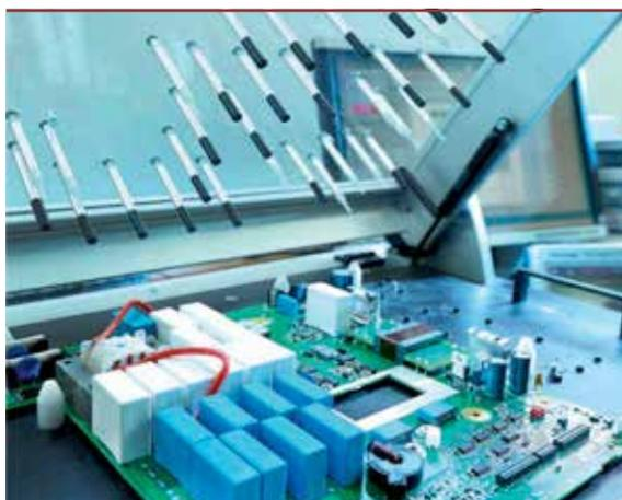
Las placas base se prueban simultáneamente en más de 500 puntos, tras lo cual se confecciona un protocolo de control.
