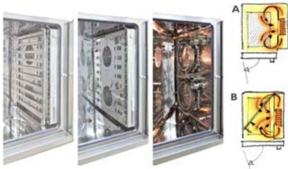
En los **sistemas tradicionales** (A), cámara y deflector son los elementos técnicos que permiten direccionar el aire caliente hacia los alimentos. Problema: cámaras de compleja construcción, componentes de difícil acceso. Con la tecnología **XT BOXTOR** (B), gracias a un exclusivo baffle®, giratorio y extraíble, que direcciona el aire caliente sobre los alimentos, se soluciona el problema: la cámara es lineal y los componentes resultan de fácil inspección.
